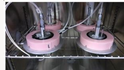
Устройство для растрескивания битумного вяжущего (ABCD)
