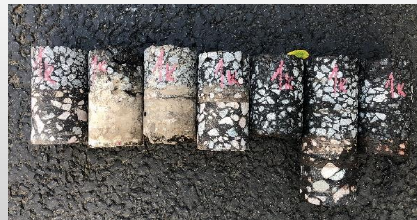
Отбор 20 асфальтобетонных кернов, выбуренных из покрытия в местах укладки а/б смесей
