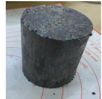
Лабораторный образец из холодной органоминеральной смеси с использованием РАП и эмульсии FF
