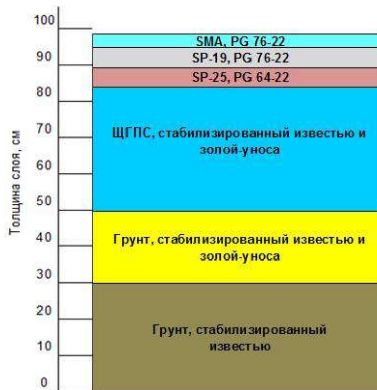
Конструкция Control PP-5
