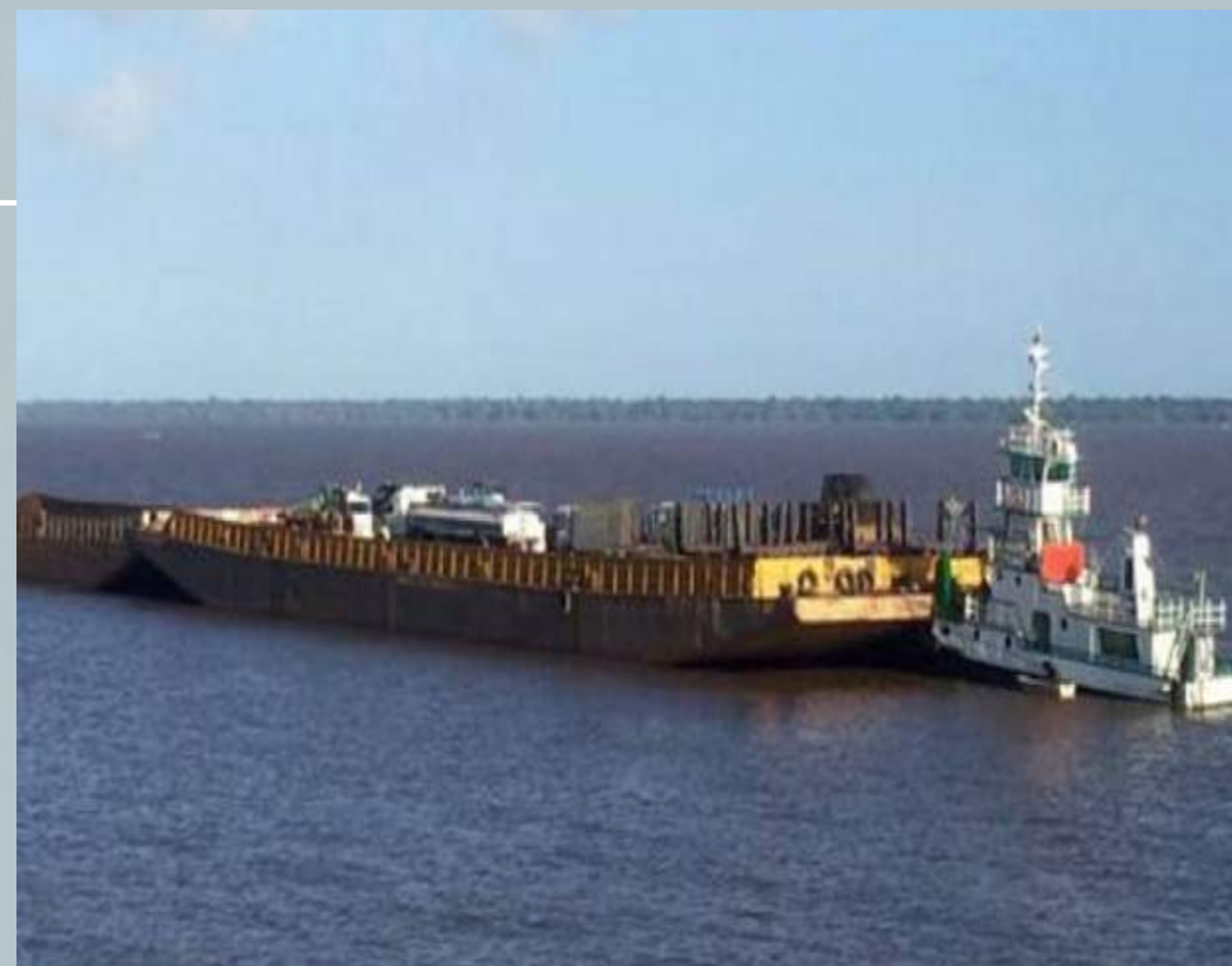
↳ Система Roll on Roll с грузовиком-цистерной на барже
