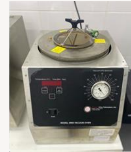
Старение PAV. Моделирование нахождения в покрытии до 10 лет.
