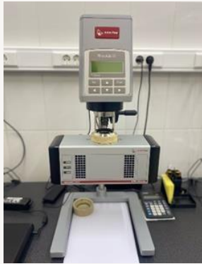
Ротационный вискозиметр. Технологические характеристики.
