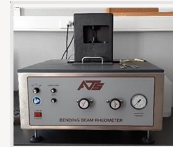
Реометр изгибающий балочку (BBR)
