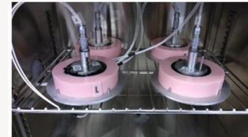
Устройство для растрескивания битумного вяжущего (ABCD)
