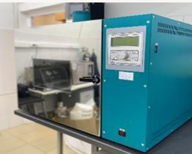
Старение в RTFOT. Моделирование состояния на момент начала эксплуатации.
