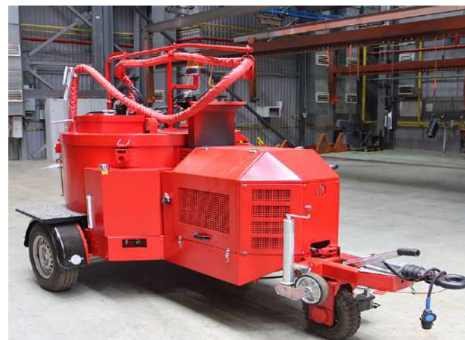
Заливщики швов производства АО «Коминвест-АКМТ» (г. Москва)
